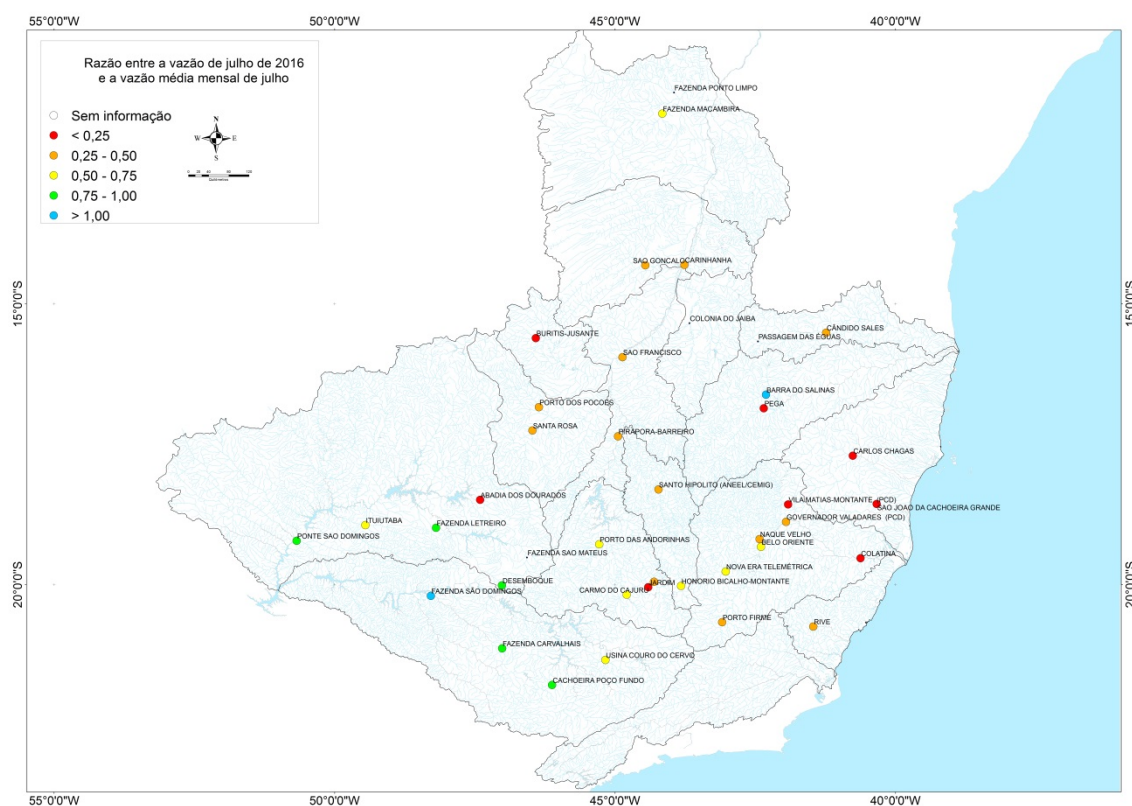
Figura 8 - Razão entre a vazão de julho de 2016 e a vazão média mensal de julho.
