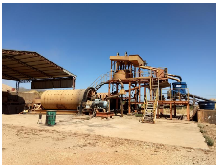
Figura 3 – Instalações para britagem e classificação de minério da concessão garimpeira Terra Vermelha (Foto: Angeval Alves de Brito).
