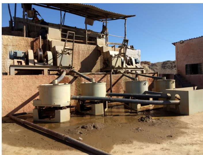
Figura 3 – Instalações para britagem e classificação de minério da concessão garimpeira Terra Vermelha (Foto: Angeval Alves de Brito).
