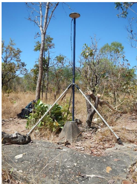
Figura 26 - Antena de GPS operando sobre marco do furo NA-03-TO.
