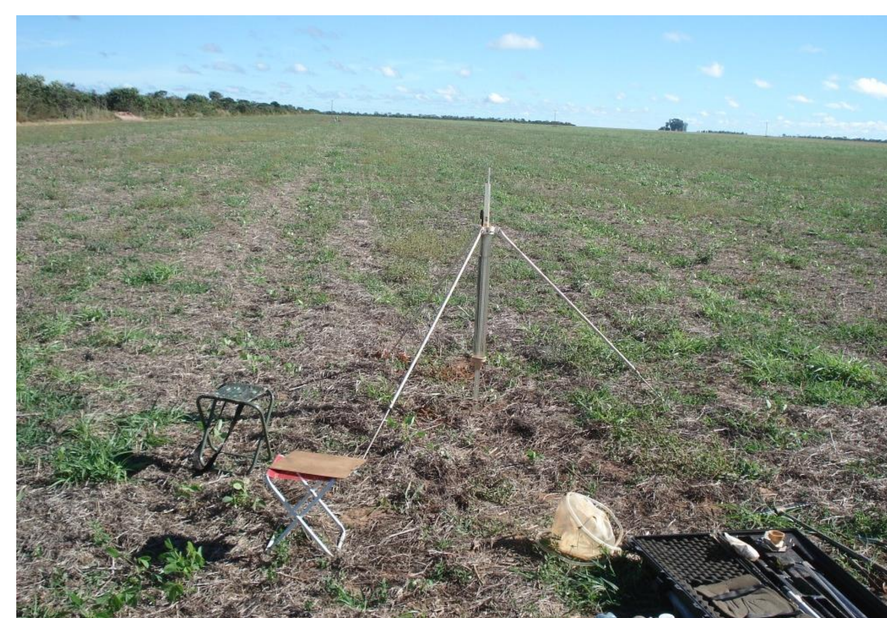
Figura 1. Permeâmetro de Guelph no campo.
