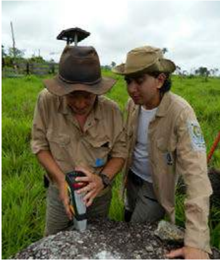
Pesquisadores da CPRM verificam composição química de rocha com uso de fluorescência de Raio X
