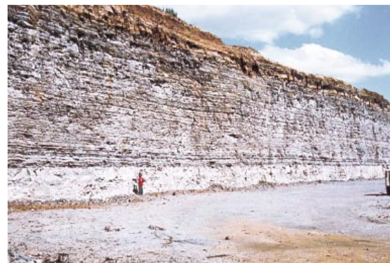
Pedreira da Calcário Vitti, Formação Irati, onde a relação estéril-minério pode ser nitidamente observada. O banco dolomítico, de cor clara uniforme, é recoberto em contato nítido por ritmitos de cor cinza. Projeto Rochas Carbonáticas da Borda Leste da Bacia do Paraná.
