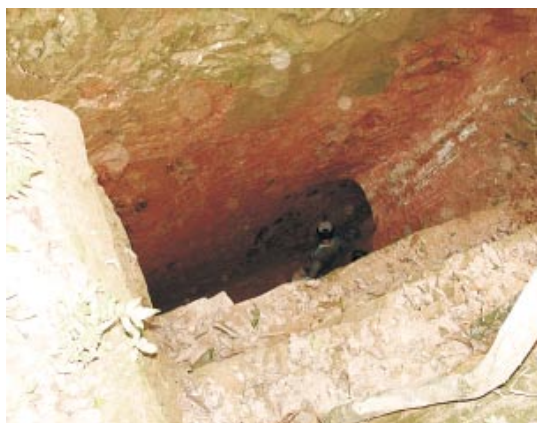
Cava vertical de garimpo em filão desenvolvido dentro do contexto geológico das rochas vulcânicas da Suíte Colíder. Projeto Estudos de Geologia e Metalogenia da Província Aurífera Juruena-Teles Pires.
