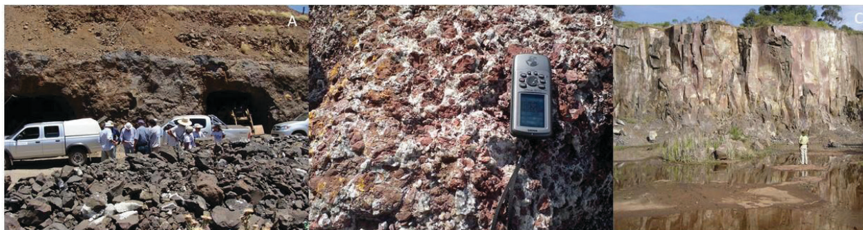
Figura 3 (A) Galerias de lavras de ametista no Distrito Mineiro Los Catalanes, UY, com rejeitos de rochas andesíticas. (B) Brecha de crosta superior do derrame rubbly pahoehoe D7, da Formação Alegrete., Município de Santana do Livramento. Notar cimento calcítico em cor branca. (C) Pedreira em basalto, nos arredores da zona urbana de Três Passos. Notar juntas colunares decimétricas a sub-métricas indicando derrame espesso.
