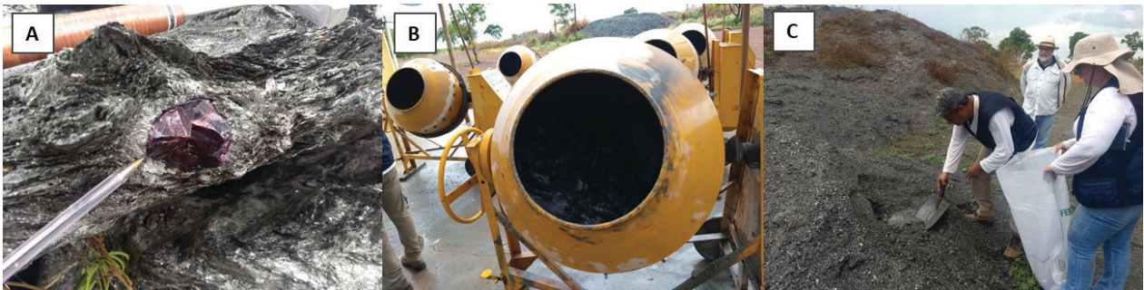
Figura 02: (A) Mineração Rodolita: biotitito/flogopitito mineralizado à granada; (B) Processo de beneficiamento do minério feito por fragmentação em betoneiras, após lavagem por jateamento de água e; (C) Amostragem em pilha de estocagem da mineradora.
