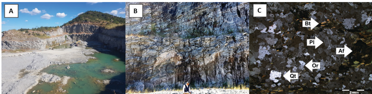
Figura 04: Em (A) Cava a céu aberto da Pedreira CMB; (B) Bandamento gnáissico evidenciando variação composicional na frente de lavra da CMB (C) Fotomicrografia da amostra de anfibólio biotita granodiorito gnáissico, com plagioclásio (Pl) 40%, biotita (Bt) 25%, anfibólio (Af) 15%, ortoclásio (Or) 10%, quartzo (Qt) 10% e epidoto tr. Notar nível mesocrático granolepidoblástico com anfibólio alterando para biotita.
