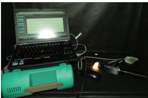
Figura 2. Espectrorradiômetro FieldSpec 3 Hi-Res ® -ASD, de resolução espectral entre 0,35 e 2,5 \mu\text{m} , utilizado para a caracterização do comportamento espectral de minerais e rochas.
