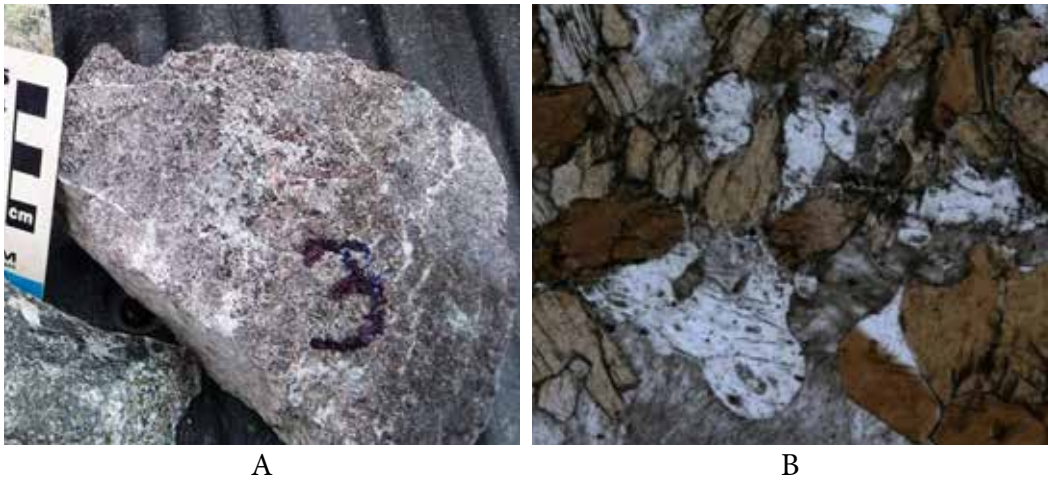
Figura 3 – (A) Detalhe do serpentina-flogopita mármore (3) presente no rejeito da lavra Ipueira e (B) Fotomicrografia (LNX02) evidenciando agregados lamelares de flogopita (mineral castanho-claro) que envolvem parcialmente agregados fibrolamelares de serpentina (mineral branco).
