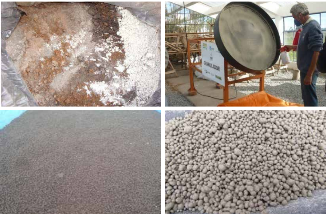
Figura 6 – Ilustração da mistura de diferentes tipos de rochas (blendagem), do granulador artesanal utilizado e de produtos finais peletizados e granulados. Embrapa Clima Temperado, 2016.
