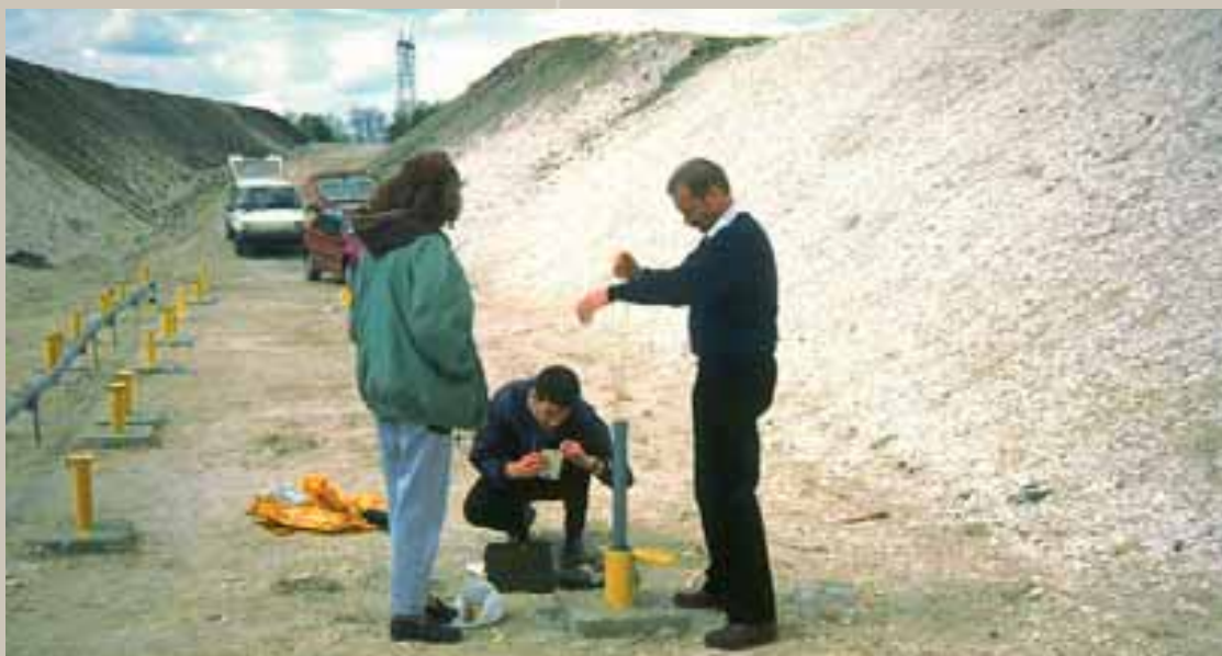
◀ Mesures dans un piézomètre lors de l'opération de dépollution de la nappe à Mazingarbe, dans le nord de la France. Measurements in a piezometer during a groundwater de-pollution campaign in Mazingarbe, northern France.
