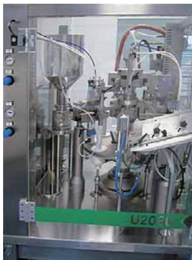
◀ Photo 6 : Machine pour la mise en tube des pommades. Photo 6: Tube-filling machine for ointment.
