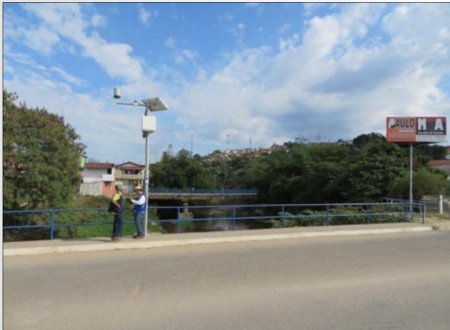
Foto: Júlio Lana – CPRM/SGB Sistema de medição de nível de rio em Carlos Chagas/MG.
